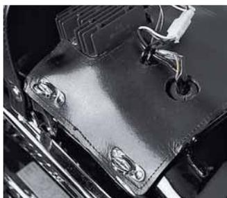
» Utilizzare la base di montaggio universale (Art. 4718) e fissarla sotto il sedile.
