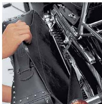
» posizionare la borsa sui due gancini rotanti posti sulla base. Tenerla in posizione con il perno di sicurezza 4720 e il lucchetto a combinazione 4721 o 4725.
